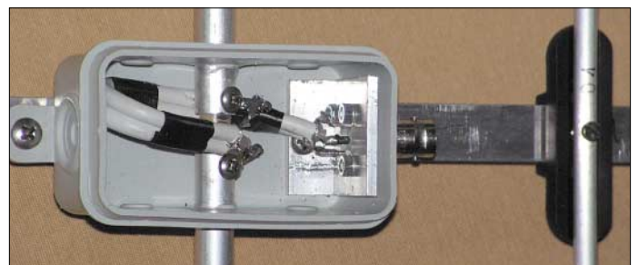
Bild 2: Innenansicht der Strahlerdose bei einer 70-cm-Yagi
