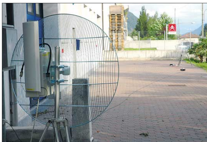
Bild 2: Konventionelle Geräte dienen als Basis für die Hotspots. In den Plastikkästen sind die Module für die Spannungsversorgung via Ethernet untergebracht.
