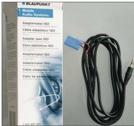
Eine funkfremde Lösung sind die Autoradioadapter von Blaupunkt , die einen am iPod -Kopfhöreranschluss anschließbaren Stecker besitzen. Vorteil: Funktioniert auch mit beliebigen anderen Geräten mit 3,5-mm-Klinkebuchse für Kopfhörer.
