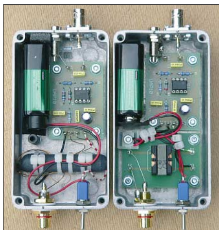
Bild 4: Zwei einfache, aber wirkungsvolle und sowohl für Erd- als auch für Baumanntenen geeignete Antennenanpassverstärker; die Potenzialtrennung erfolgt nach den Verstärkern beim linken durch eine Stabkernwicklung und beim rechten durch ÜK1.
