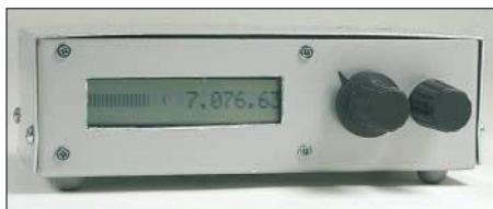
Bild 6: JUMA-RX1 bereit für den Empfang; meine handwerkliche Ausführung der Gehäusedurchbrüche ist noch verbesserungswürdig.
