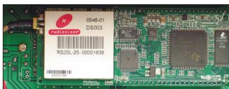
Dieses Modul von RadioScape ist für Empfang und Demodulation zuständig.
