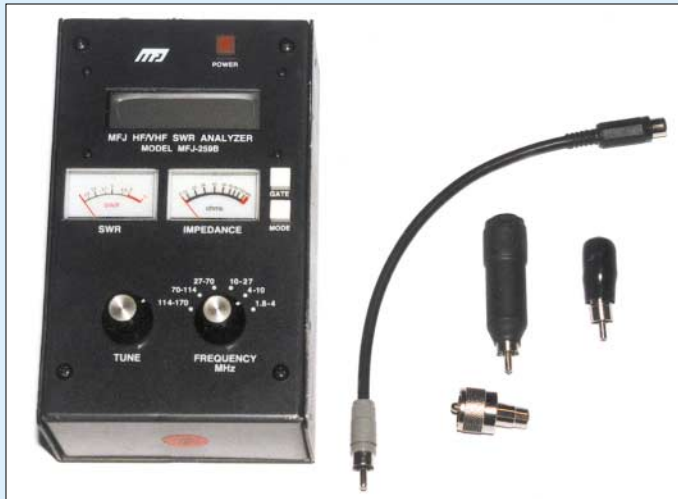
Bild 1: Der SWR Analyzer MFJ-259B mit den beiden Dipmeter-Spulen, dem Cinchadapter und der Messleitung
