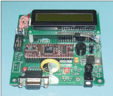
Bild 1: Im Versuchsaufbau wurde zur Softwareentwicklung das STAVER-40-Evaluation-board verwendet – damit kann man leichter die Zahlenwerte für den Luftdruck prüfen.
