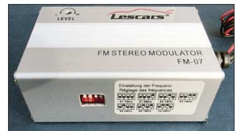
Die Frequenzwahl geschieht am Lescars FM 07 per DIP-Schalter, die nach dem Einbau nicht mehr zugänglich sind.
