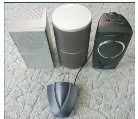
Drei untereinander kompatible Funklautsprechermodelle von Tevion (bei Aldi erhältlich), die oberhalb 863 MHz in FM empfangen und davor ein dazu passender Sender; die lange Leitung am Sender ist die Stromversorgung, die Antenne ist der kurze Drahtstaken oberhalb. Bei den Empfängern ist die Antenne im Inneren der Lautsprecher versteckt und von außen nicht sichtbar.
