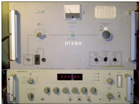
Der 130-W-Seefunksender DEBEG-7121 (oben), der bei DI2BO wieder in Dienst gestellt wurde.
